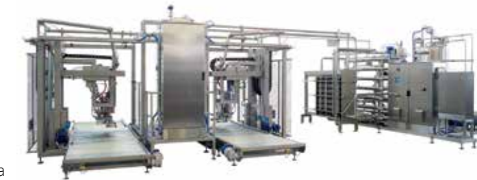
SteriTherm Стерилизатор и асептичен полнач за концентрирана шира
